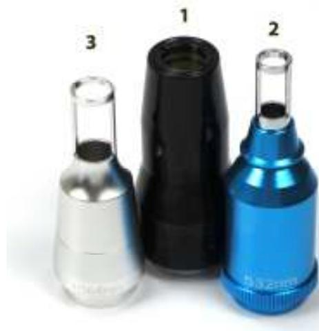
Рис. 4. Фильтры лазера.
